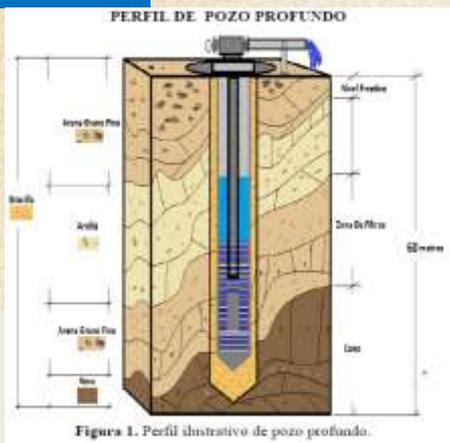
Perforación, adecuación y entrega en funcionamiento de un pozo profundo de agua subterránea con camisa en acero al carbono y filtros de Acero inoxidable. Caudal esperado 40 litros por segundo
