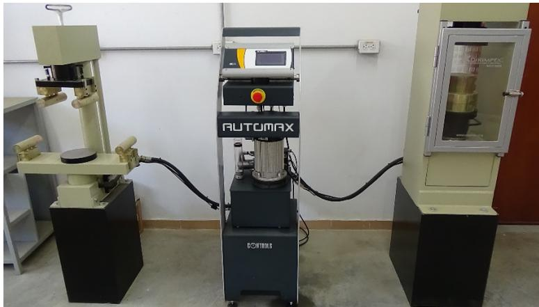
Máquina para ensayos a flexión y compresión de probetas de concreto
