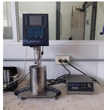
viscosímetro rotacional con termosfera
