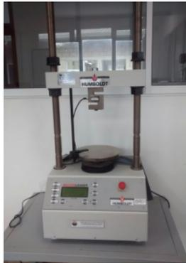
Máquina digital para ensayos a compresión master loader.
