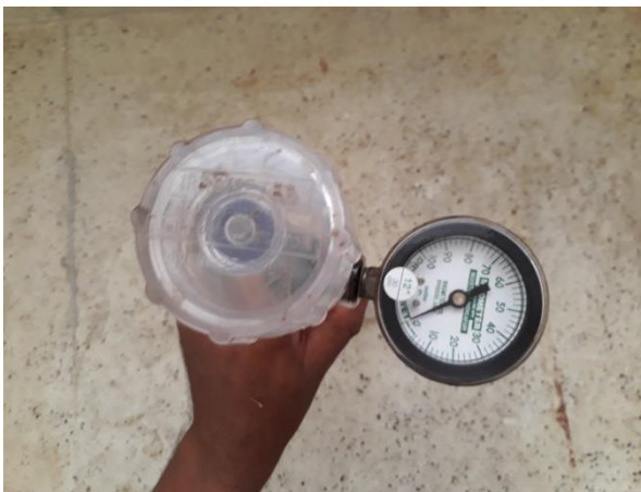
Figura 7.5. Tensiómetro con manómetro para monitorear la humedad del suelo.
